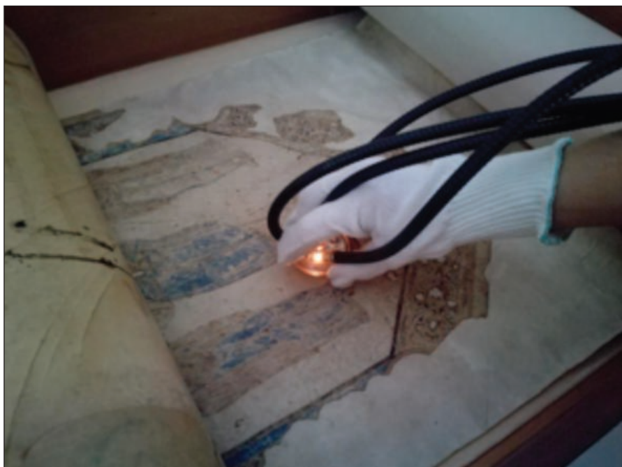
Foto 1. Analisi dei pigmenti mediante l'uso della Spettroscopia di riflettanza Fors.
